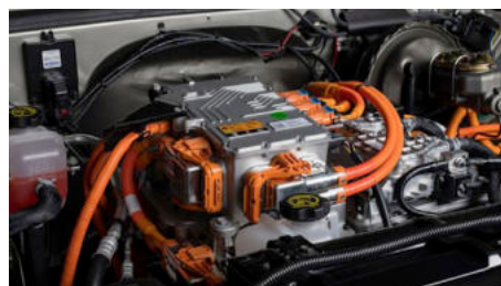
KREISEL(오스트리아) / Mercedes-Benz G350d / 360 kW 전기모터, 최고속도 183 km/h 0→100 : 5.6s
