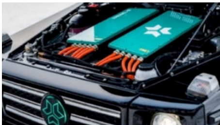
KREISEL(오스트리아) / Mercedes-Benz G350d / 360 kW 전기모터, 최고속도 183 km/h 0→100 : 5.6s
